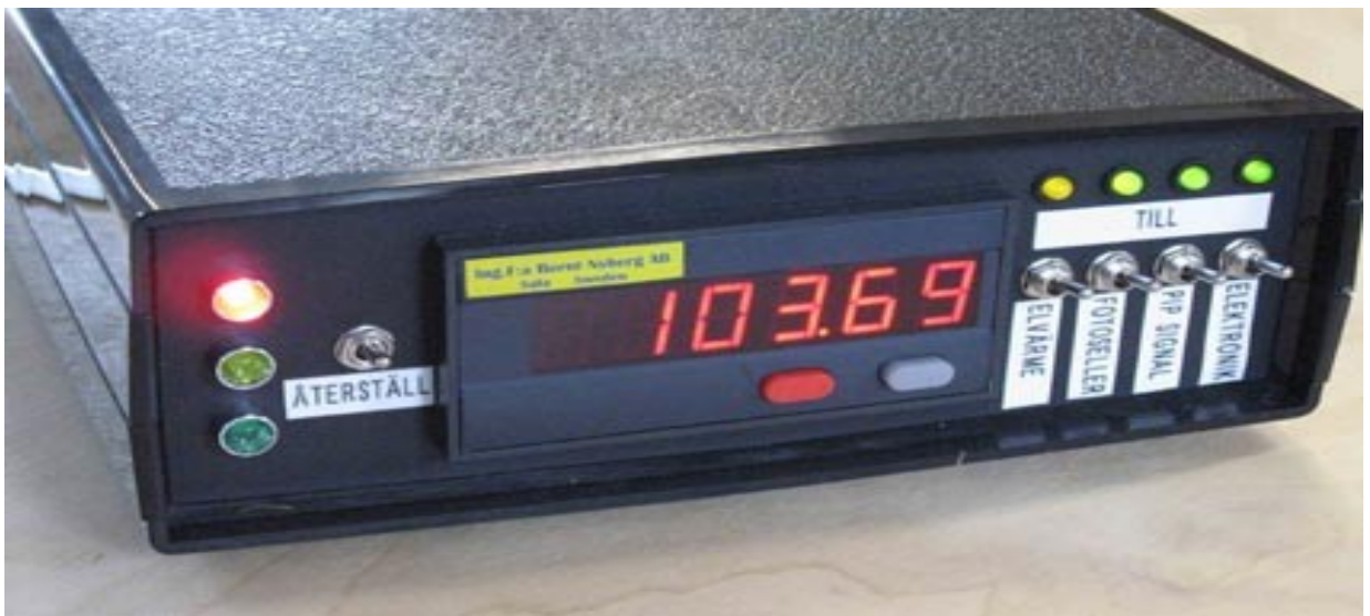
Bild 2: Elektronikenheten. Till vänster: "Trafikljuset" och återställning. I mitten Display. Till höger strömbrytare för elvärme, fotoceller, pip och elektronik. Den röda och den grå knappen under displayen används normalt inte.
